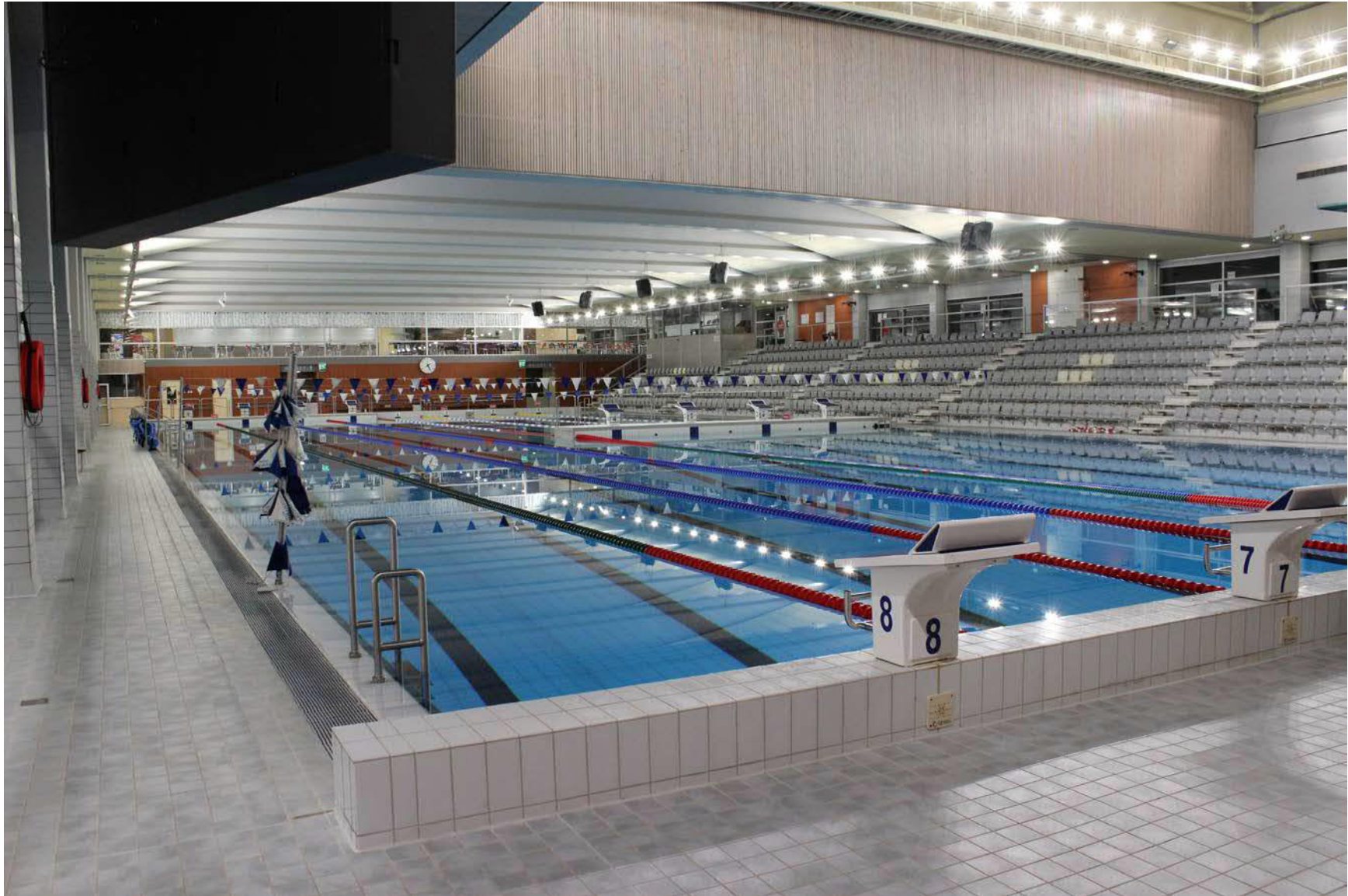
64. Nykyinen väri- ja materiaalimaalima on monimuotoinen. Lattioiden valkoinen nappulalaatta on vaihdettu siniharmaaseen himmeään laattaan. Betonipilarit on laatoitettu ja seinäelementtien betoni on maalattu harmaalla tai vaaleankeltaisella. Puurimoitus on käsitelty alkuperäistä vaaleammalla kuultoväriillä. Ikkunoissa on vaaleankeltaiset pimennysverhot.
