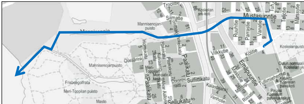
Kuva 3. Selvitysalueelta hulevesiverkostoon johdettavan huleveden reitti purkupisteeseen esitettyinä kuvassa sinisellä viivalla. (reitti perustuu Oulun kaupungin aineistoon)
