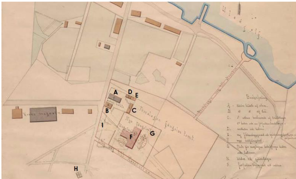
Kuva 12 Ote vankilan vuoden 1882 asemapiirustuksesta. Piirustukseen merkityjä rakennuksia ovat vanha vankila kivistä (A), vanha vankila puusta (B), ulkorakennus (C), puuvaja (D), karjasuoja (E), uusi sellivankila (F), paikka mahdolliselle vajalle (G), vanha "velkavankila" sekä luhistunut rakennus (I). Kuva: rakennushistoriaselvitys.
