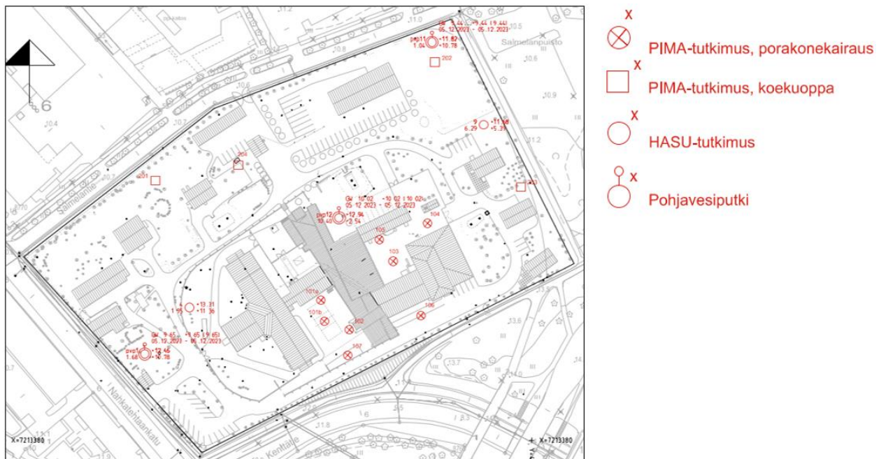
Kuva 23 Tutkimuspisteiden toteutuneet sijainnit kartalla. Kuva: sulfaattimaaselvitys.
