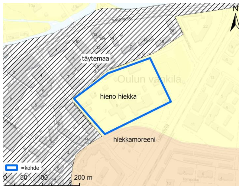
Kuva 24 Ote maaperäkartasta (Maankamara, GTK 2023), missä vankilakiinteistö on rajattu sinisellä. Kuva: rakennettavuus selvitys.
